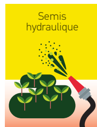
Projection d'un mélange de graines, d'eau et d'engrais.
