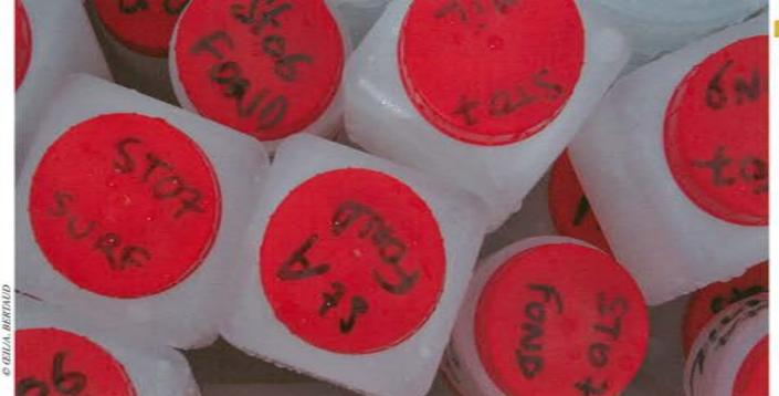
Des échantillons d'eau ont été prélevés pour être envoyés en métropole pour analyse, notamment pour connaître les concentrations en cobalt, manganèse, mickel et sulfate
